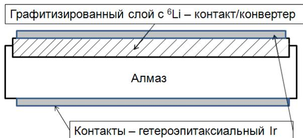
Рис. 2. Схема алмазного детектора с графитизированным контактом/конвертером на основе алмаза, имплантированного  ${}^6\text{Li}$
