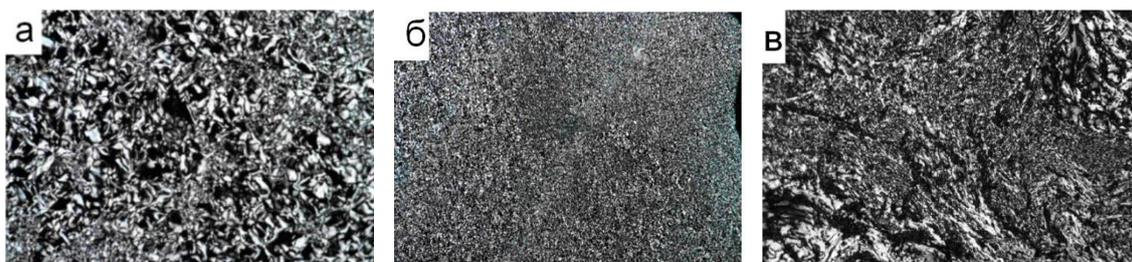
Рис. 1. Микрофотографии коксов из пеков: а – ПО2; б – ПО3; в – ПО3,5
