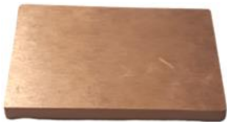
Рис. 2. Опытный образец AlSiC с металлизацией слоя титана и меди, а также гальваническим осаждением меди
