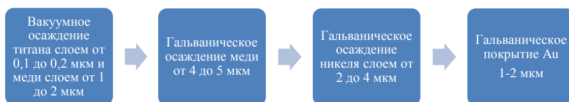
Рис. 1. Технологическая схема металлизации металломатричного композита AlSiC Fig. 1. Technological scheme of metallization of AlSiC metal matrix composite
